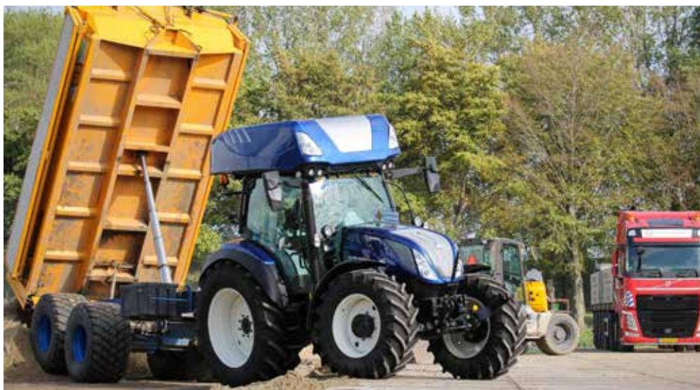
De vier waterstofftrekkers worden inmiddels bij Scholman ingezet in de praktijk. De trekkers zullen zoveel mogelijk worden ingezet op projecten waarbij waarde wordt gehecht aan duurzaamheid.
