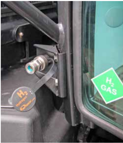
Waterstof tanken gebeurt via deze koppeling, die boven de tankdoppen van diesel en AdBlue is geplaatst.
