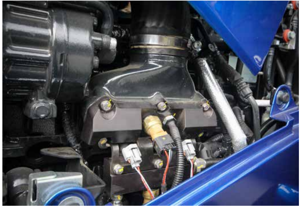
Hier wordt waterstof met 8 bar in de luchtinlaat verneveld. Er wordt tot maximaal 65% waterstof ingespoten, en die hoeveelheid hangt af van verschillende parameters zoals het gevraagde vermogen.
