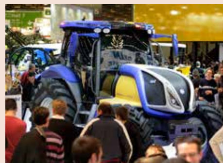
New Holland presenteerde deze trekker in 2009. Hij werkte met een brandstofcel die ter plekke door middel van elektrolyse waterstof omzette in elektriciteit.
