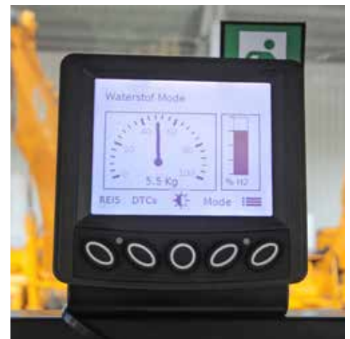
Links het vulniveau (nog 5,5 kg waterstof over). Het balkje rechts toont de actuele inspuiting; hier een uitschieter naar 75%.
