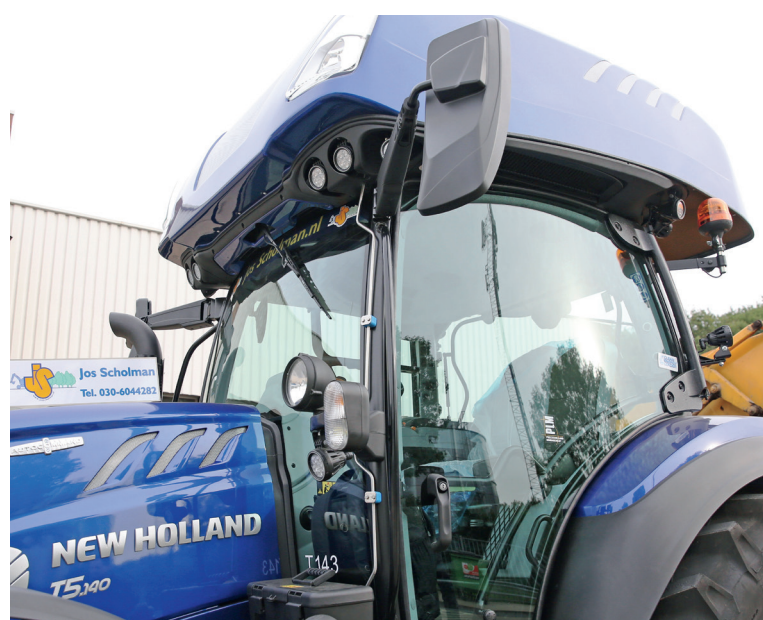
Via een leidinkje langs de cabine stijl komt de waterstof van het vulpunt, net boven de dieseltank, in de tanks op het dak.
