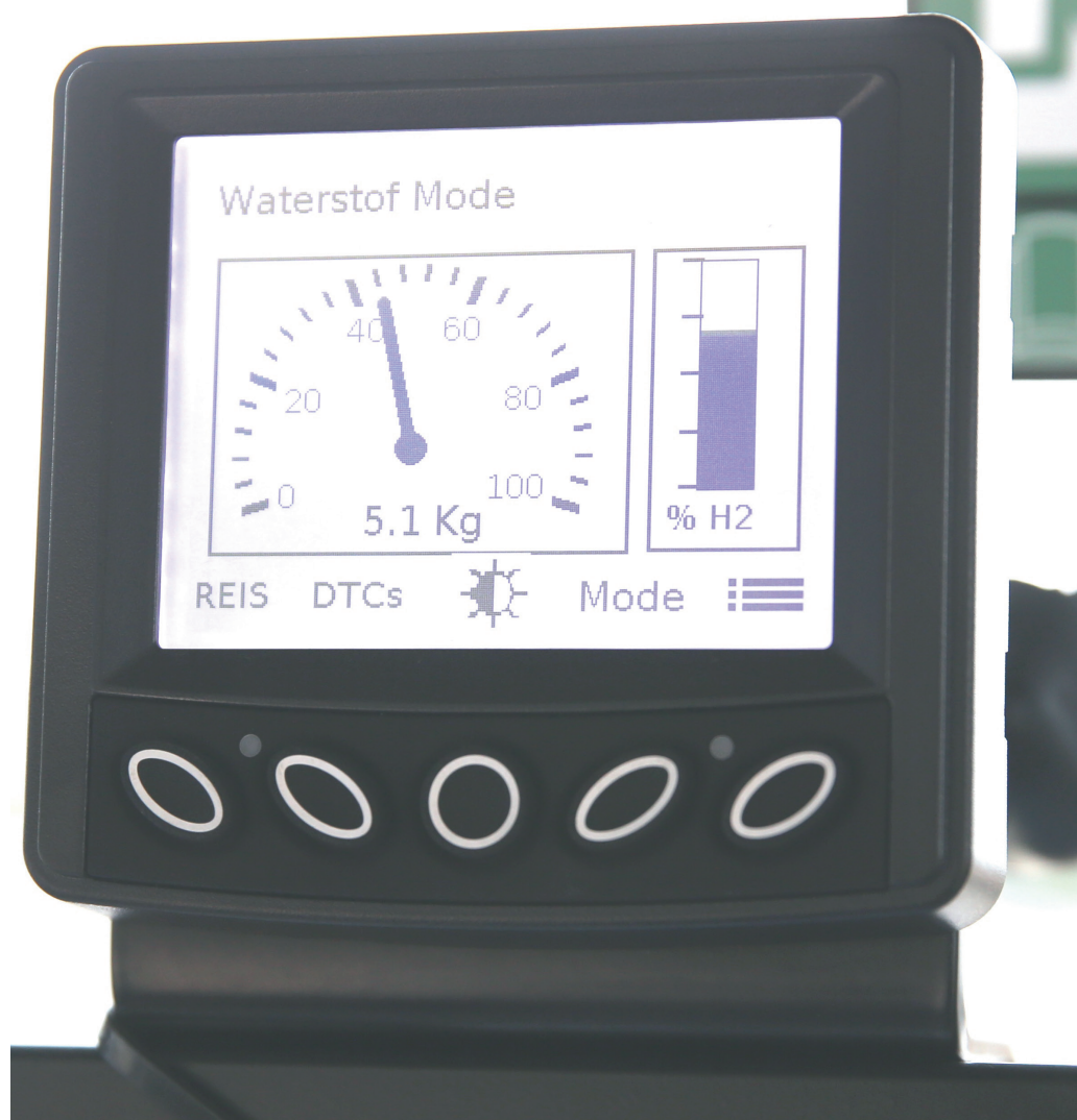
Op het display in de cabine zie je aan het blauwe balkje het percentage waterstof dat wordt ingespoten. Links de hoeveelheid in de tank.
