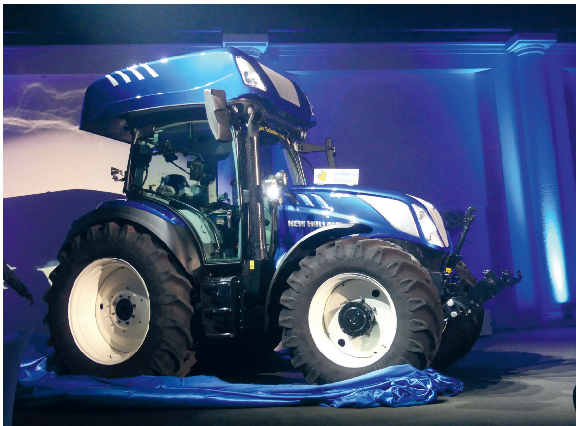
De standaard New Holland T5.140 Autocommand heeft waterstof als extra energiedrager.
